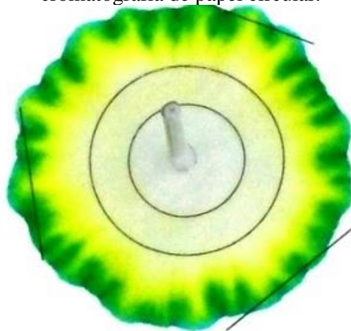
Figura 4: Separación de los pigmentos de la tinta de un rotulador verde usando la cromatografía de papel circular.
