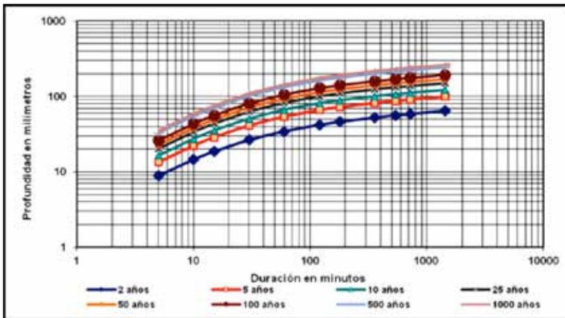
**Gráfico 3.** Curvas de Profundidad - Duración - Frecuencia (PDF) para láminas máximas anuales de precipitación (período 1962-1994) de la estación Borburata, estado Carabobo, Venezuela.
