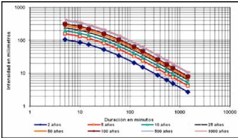
**Gráfico 4.** Curvas de Intensidad - Duración - Frecuencia (IDF) para láminas máximas anuales de precipitación (período 1962-1994) de la estación Borburata, estado Carabobo, Venezuela.
