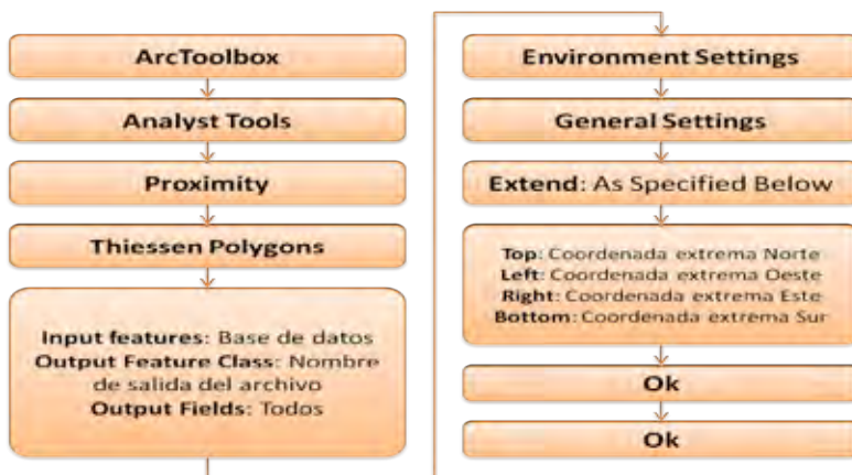
Gráfico 1. Rutina de procesamiento para la creación de Polígonos de Thiessen en el software ArcGis.
