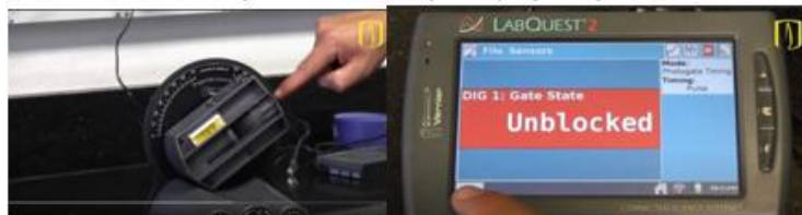
Imagen 2. Dispositivo de lanzamiento usado en el vídeo, conectado al Interface LabQuest 2 (derecha)
